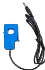
Stromsensor 100 A: 50 mA Zur Umsetzung der PowerControl und PowerAssist Funktionen und zur Optimierung des Eigenverbrauchs mit externer Strommessung. Maximaler Strom: 50 A bzw. 100 A. Länge des Anschlusskabels: 1 m
